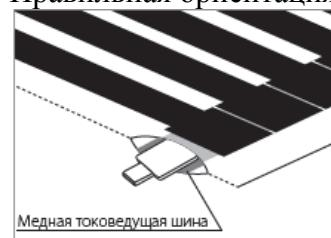
При помощи пассатижей или специального монтажного инструмента обожмите зажим, установленный на токопроводящейшине.
